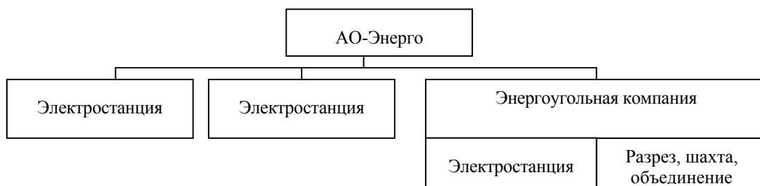
Рис. 1а. Схема энергоугольной компании, состоящей из электростанции и угледобывающего предприятия – самостоятельных юридических лиц
